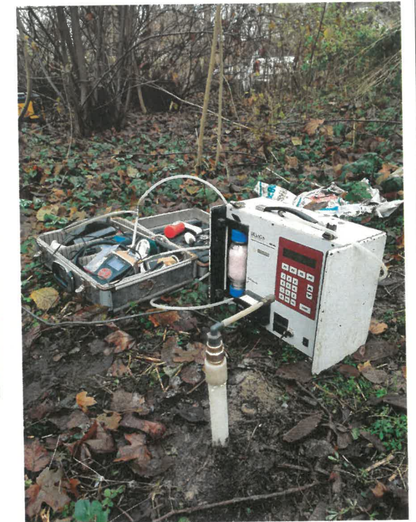
Foto 4: Probenahme Bodenluft an T2-2
